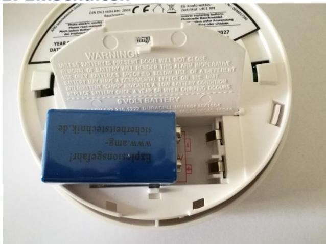
Die Folie von der Blockbatterie entfernen und einlegen. Danach ist der BTS Rauch-/Hitzemelder automatisch eingeschaltet. Durch die plötzliche Spannungsversorgung sendet der Rauchmelder die Meldung „**Batterie leer**“ zur Zentrale. Diese können Sie einfach löschen.
