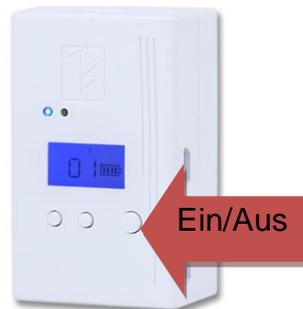
Sobald die Zentrale das Funksignal empfängt, wird für ca. 3 Sekunden eine Information im Display der Zentrale eingeblendet. In dieser Information wird der Name des Senders, die Sender Nummer und die Signalstärke des Funksignals in der Stärke 0 (sehr schwach) bis 4 (sehr stark) angezeigt.
