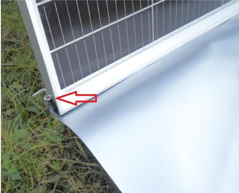
Mit Windböen muss jederzeit gerechnet werden. Damit Ihre Solarmodule nicht vom Wind umgeworfen und ggf. beschädigt werden, verfügen sie am Solarmodul und den Ständern über Ösen, mit denen sie befestigt werden können.
